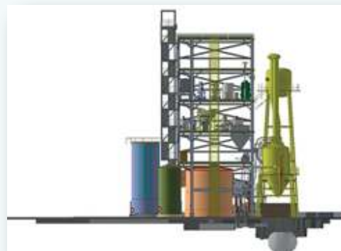
Planta de tratamiento de agua residual vertical
